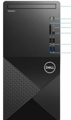
За свързване на устройства като външни устройства за съхранение на данни и принтери. Осигурява скорост на трансфер на данни до 5 Gbps.
