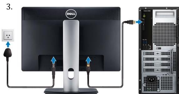
**Бележка:** Мястото за свързване на дисплей кабела може да варира, ако компютърът ви има инсталрирана дискретна графична карта. За оптимална графична производителност, моля уверете се, че сте свързали дисплей кабела към графичната карта, ако има инсталрирана такава.
